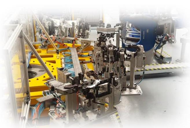
Porsche PO356 Dettaglio Impianto rivettatura traversa posteriore
