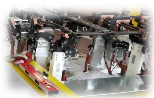
FCA 520/334 Stralcio Isola saldatura ad arco schienale sedile
