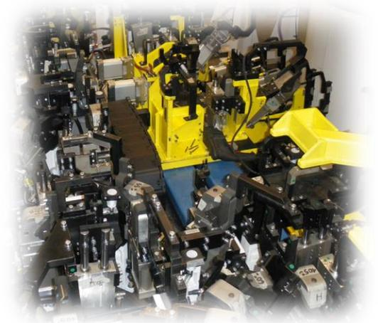
Iveco Daily 2014 Suzzara Impianto assemblaggio e saldatura ossatura fiancata
